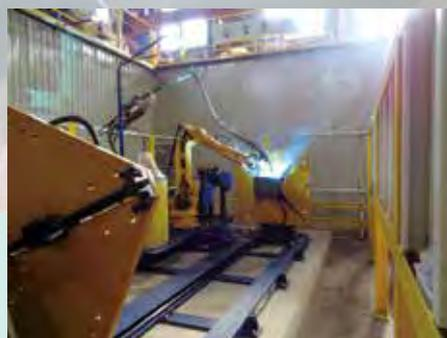
溶接中のロボットシステム
